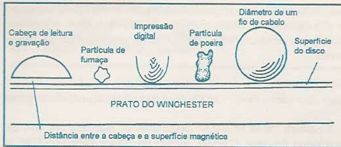
fig 1 - distância entre a superfície do disco WINCHESTER e a cabeça de leitura e gravação comparada com alguns tipos de partículas
