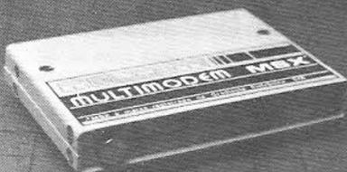
Modem cartucho para micro-computadores MSX. Velocidades de 300 e 1200/75 bits/s. Permite o acesso ao Renpac, Cirandão, Videotexto e Aruanda, além da comunicação micro-à-micro. Compatível com as normas CCITT V.21, V.23, BELL 103 e BELL 202. Incorpora a interface RS-232, e não requer nenhum acessório para operação. Acompanha software de comunicação.
