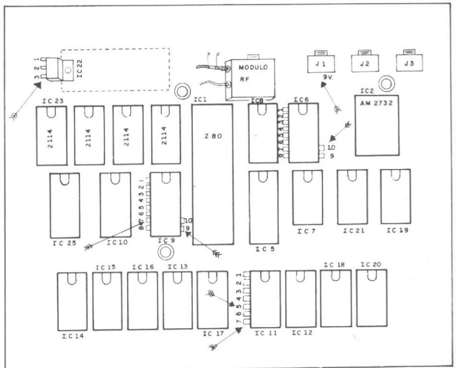
Figura 7 - Layout dos componentes do TK82-C, versão antiga.
