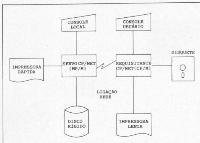
Figura 4 - Configuração básica de um sistema CP/NET
