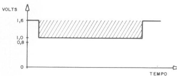
Figura 5 – Modo RUN: 1 volt, nível lógico 1.
