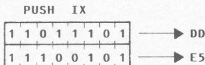
*Descrição:* O conteúdo do registrador indexador **IX** é colocado no **STACK**. Esta instrução primeiro decrementa o **STACK POINTER** e move o byte mais significativo do registrador **IX** para o endereço de memória especificado por **SP**, para, em seguida, decrementar novamente o **STACK POINTER** e mover o byte menos significativo do registrador **IX** para o endereço de memória especificado por **SP**. O **STACK** é utilizado para o armazenamento temporário do conteúdo de um registrador.
