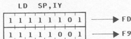
*Descrição:* O conteúdo do registrador indexador **IY** de 16 bits é transferido para o registrador **STACK POINTER (SP)** de 16 bits.
