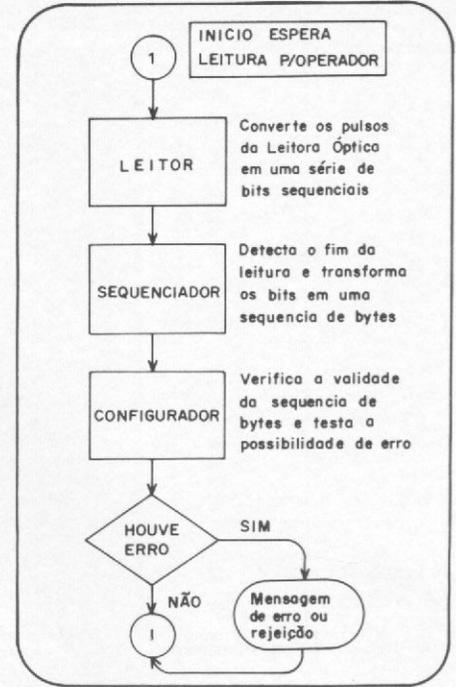
Figura 4 — Esquema simplificado do software de decodificação dos códigos de barras.
