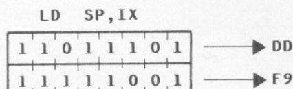
*Descrição:* O conteúdo do registrador indexador **IX** de 16 bits é transferido para o registrador **STACK POINTER (SP)** de 16 bits.
