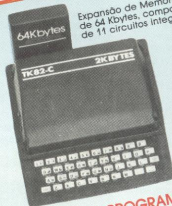
Expansão de Memória de 64 Kbytes, composta de 11 circuitos integrados.
