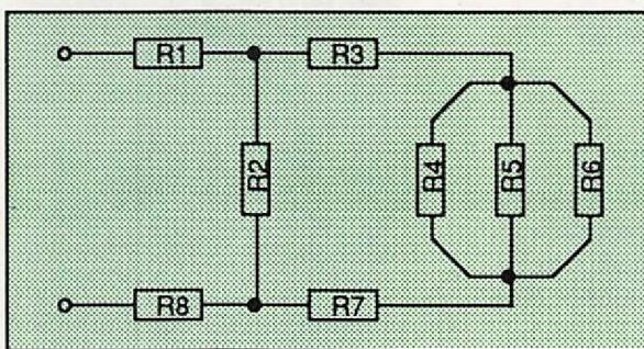
Calculer la résistance équivalente au circuit ci-dessus :
