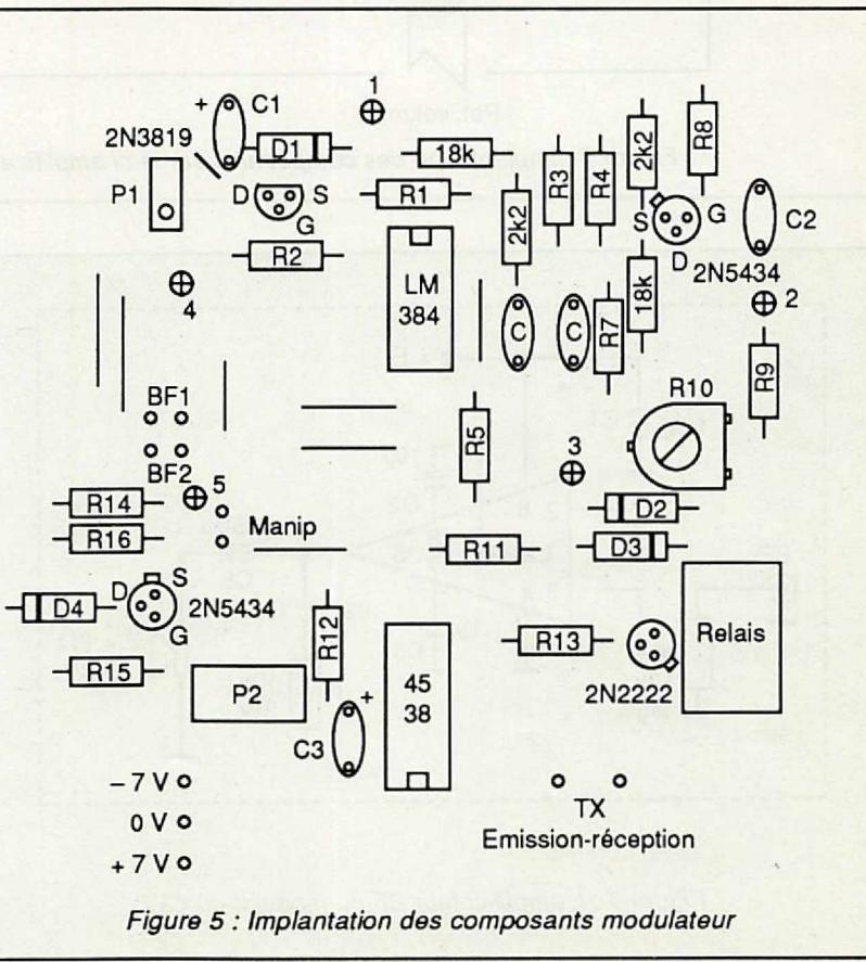
Figure 5 : Implantation des composants modulateur
