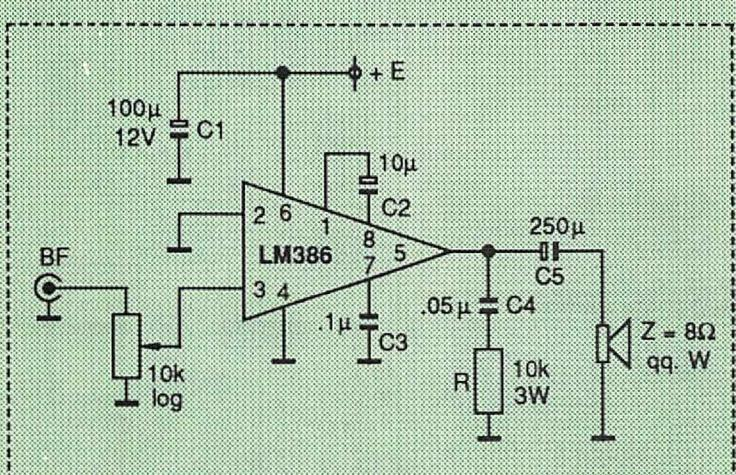
Figure 3 : L'amplificateur BF du modulateur CW
