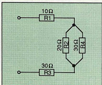
Le calcul utilisera les deux formules ci-dessous. La méthode consiste à remplacer chaque association parallèle par sa résistance équivalente.
