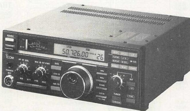
connu des amateurs mais avec une bande FM supplémentaire puisque qu'il couvre de 42 MHz à 61 MHz, donc la bande récemment attribuée de 50 MHz. L'IC 2400E est un transceiver bi-bande 144 et 432 prévu pour le montage en mobile. Deux possibilités : 45 W ou 5 W en 144 et 35 W ou 5 W en 432. L'IC 24 est aussi un transceiver bi-bande, de type portatif, très compact, avec disposant de 5 W en "forte" puissance et d'environ 500 mW en puissance réduite.
