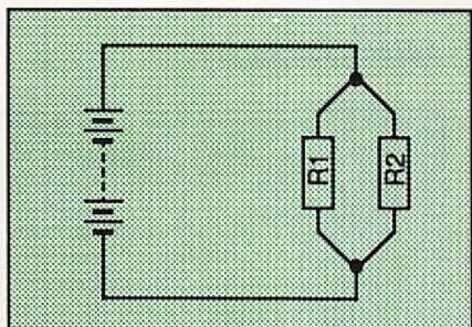
Le courant créé par la pile, traverse chacune des résistances R1 et R2 et la résistance équivalente est donnée par la formule :
