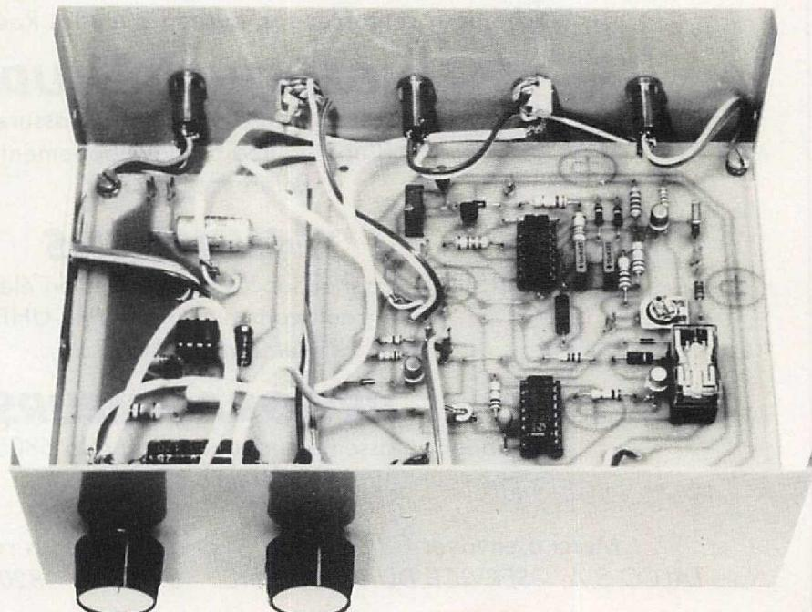
Le dispositif décrit dans cet article est essentiellement destiné à substituer le mode "télégraphie" au mode phonie sur un transceiver qui n'en serait pas muni. Certains de ces éléments constitutifs, tel l'ampli BF, pourront être utilisés dans d'autres applications.
