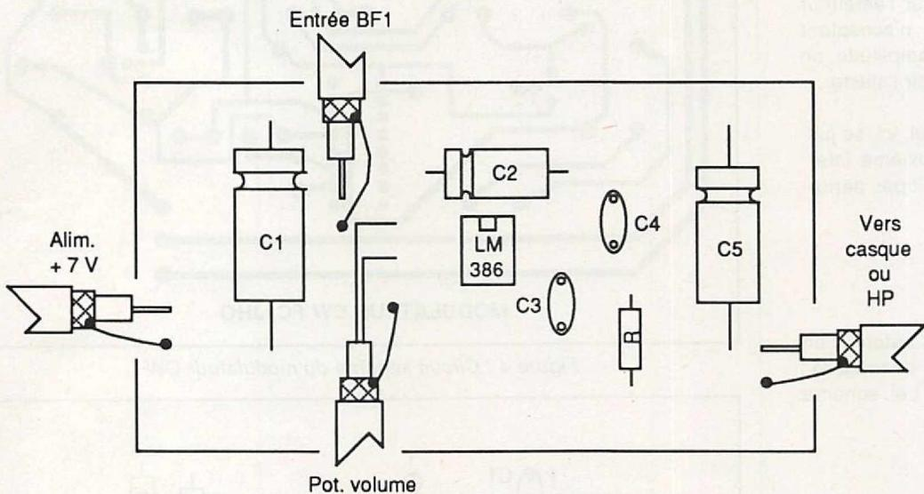
Figure 7 : Implantation des composants sur le ci amplificateur BF
