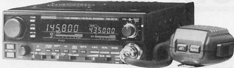
TM 721E le plus sophistiqué des transceivers bi-bandes VHF/UHF en mode FM Puissance : VHF 45 W - UHF 35 W Sensibilité : VHF et UHF : 0,3 mV = 30 dB S+B/B - 1mV : 3.8 dB S+B/B Duplex intégrale : scanning de bande ou de partie de bande et des mémoires, écoute simultanée des 2 bandes (VHF/UHF)
