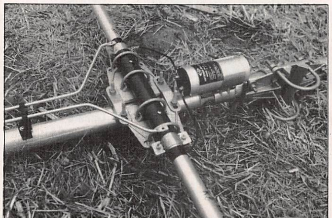
Le balun et les connexions du radiateur
