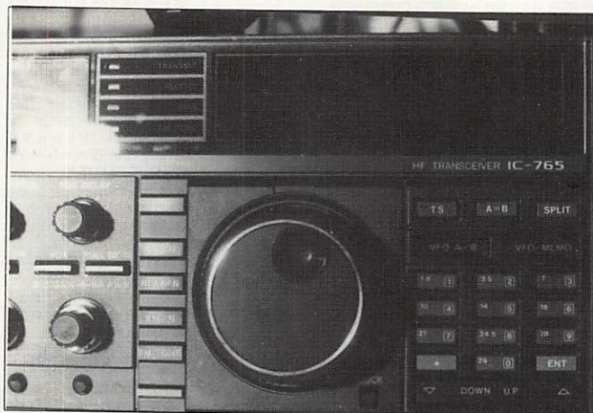
Au centre de l'appareil, les commandes de gammes et le bouton principal de variation de fréquence.
