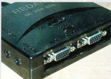
Dank Eingängen für Ton und Bild stöpselt Ihr den Adapter zwischen PC und Monitor
