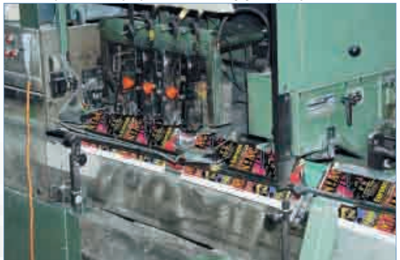
In der Oberndorfer Druckerei erfolgt die Reproduktion einer MAN!AC-Ausgabe. Im Bild sieht Ihr die vollautomatische Heftmaschine.
