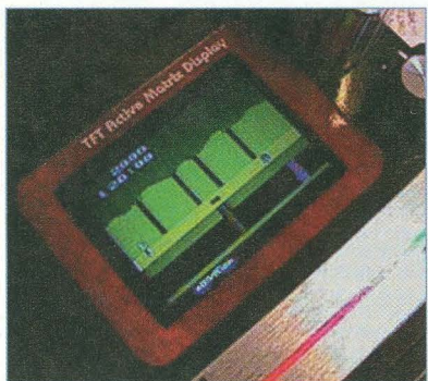
Doppelte GBA-Auflösung und Hintergrundbeleuchtung: Das Display bietet gehobene Qualität unter hohem Energieverbrauch.
