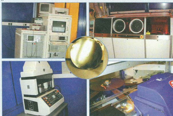
Der Computer (oben links) wandelt Daten in Pit-Strukturen um, im 'Laser Beam Recorder' (oben rechts) wird das 'Glas Master' (Mitte) erstellt. Der 'Puncher' (unten links) stanzt das Master auf CD-Größe, danach beginnt die Massenfertigung (rechts).
