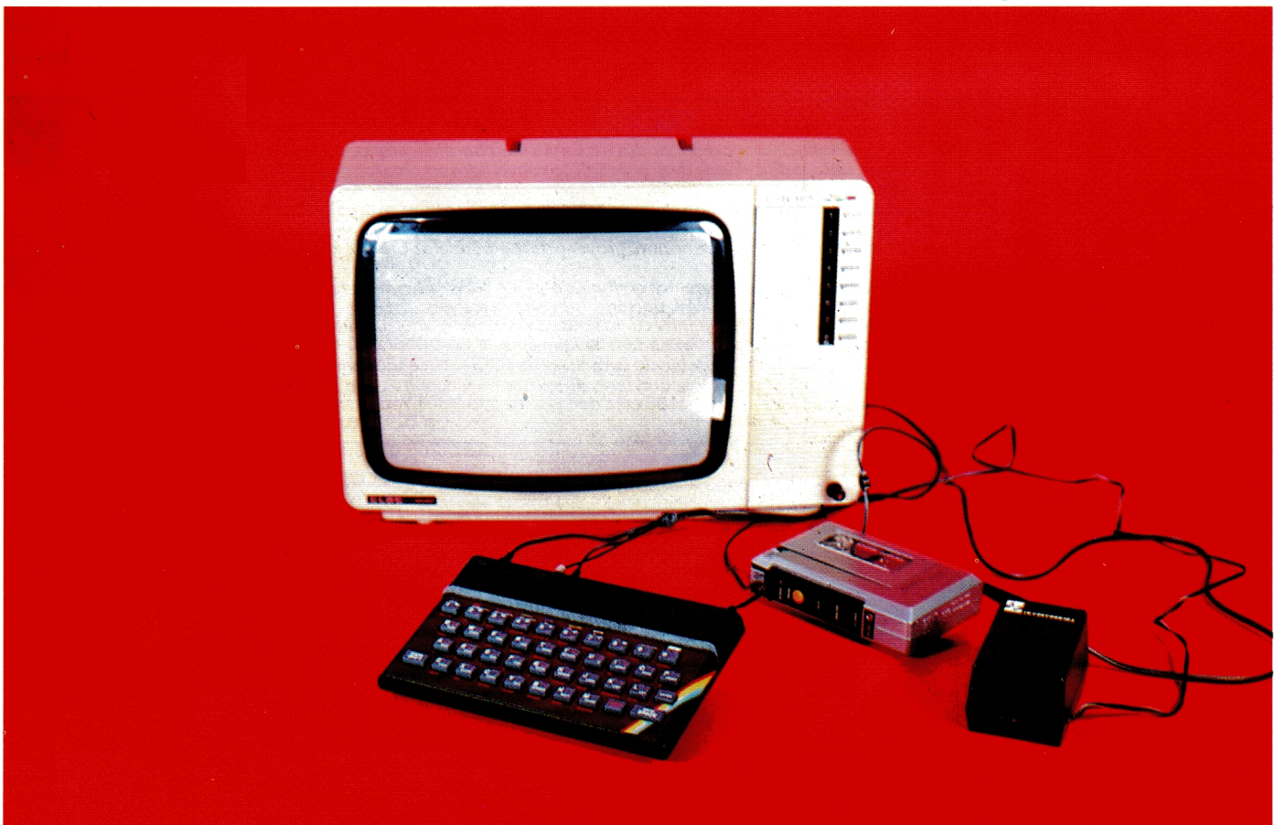
Equipamento composto pelo SPECTRUM, um televisor e um cassete áudio comercial. O televisor é um periférico só de saída, o qual representa o que introduzimos pelo teclado. O cassete é um periférico de entrada/saída para armazenamento de dados.
