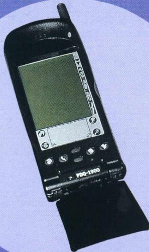
Esse é para os céticos sobre a convergência entre computador e telefone. O PHS Data Scope da Kyocera tem PDA e browser embutido, além de uma interface PCMCIA que permite conexão a um notebook
