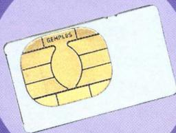
Cartão de memória SmartCard, componente obrigatório de qualquer celular GSM. Na troca do telefone por um novo, basta colocar o cartão no aparelho para que ele já comece a funcionar
