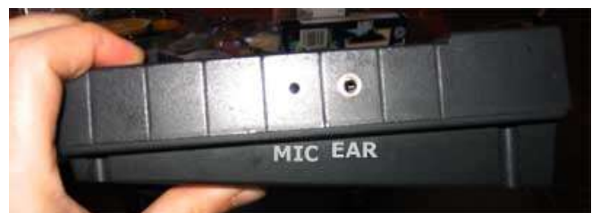
Imagen 6. Detalle de las clavijas ya colocadas (exterior)
