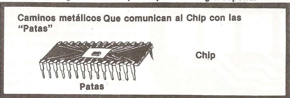
Vista de un integrado sin la capa de plástico negra superior
