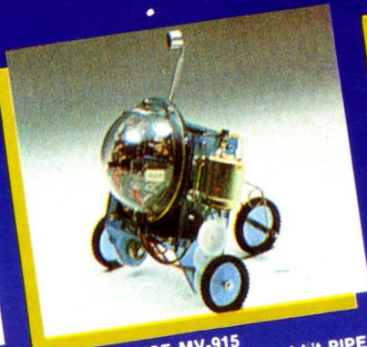
PIPER MOUSE MV-915 Usando un fischietto unito al kit PIPER MOUSE eseguirà immediatamente i comandi comunicativi: sinistra, stop, destra, stop, avanti e stop.
