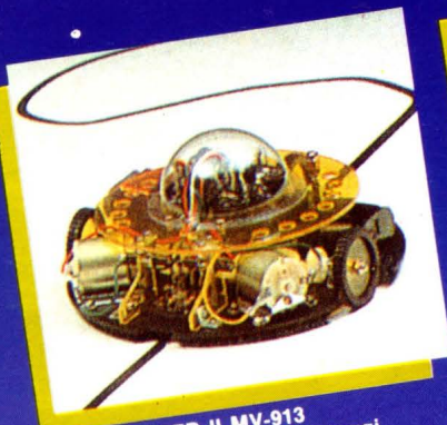
LINE TRACER II MV-913 Guidato da un sensore a raggi infrarossi questo robot segue qualsiasi linea nera tracciata su un foglio bianco.
