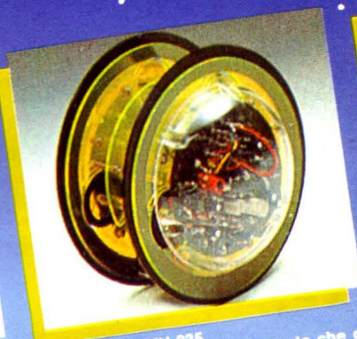
CIRCULAR MV-935 È provvisto di due grandi ruote che gli permettono di ruotare in avanti, a destra, a sinistra e su se stesso. Tutti i movimenti sono controllati mediante un comando a distanza.
