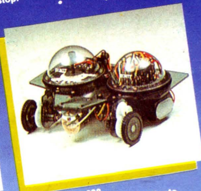
NAVIUS MV-938 È un robot controllato mediante dischetti programmabili. È in grado di riconoscere il bianco e il nero del dischetto programmato e quindi muoversi in avanti, a destra, a sinistra o fermarsi.
