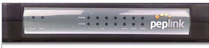
**Figura 2** O painel frontal informa a conectividade e a velocidade de operação dos links.
