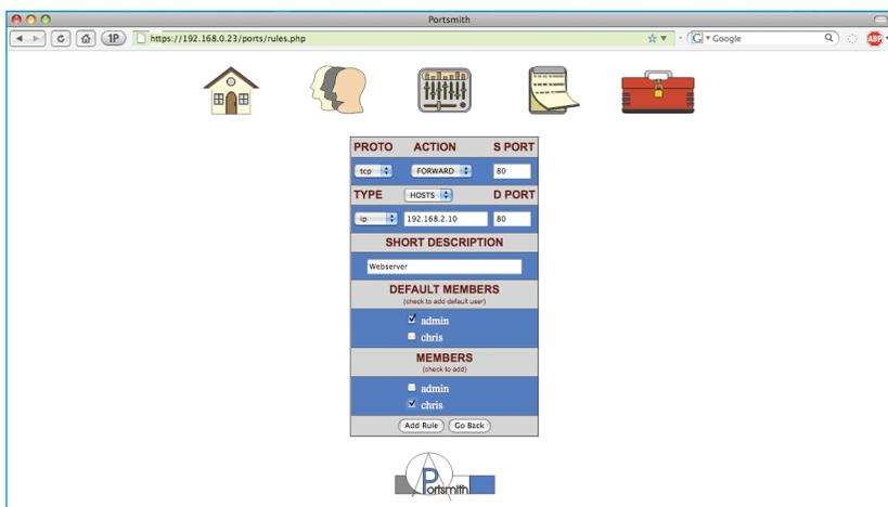
**Figura 2** Alteração das regras: o exemplo encaminha a porta 80 do firewall para um servidor web interno.
