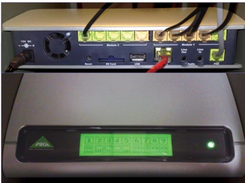
**Figura 1** Diversos conectores na visão traseira do PIKA Warp, enquanto a frente do aparelho exibe um display muito útil.
