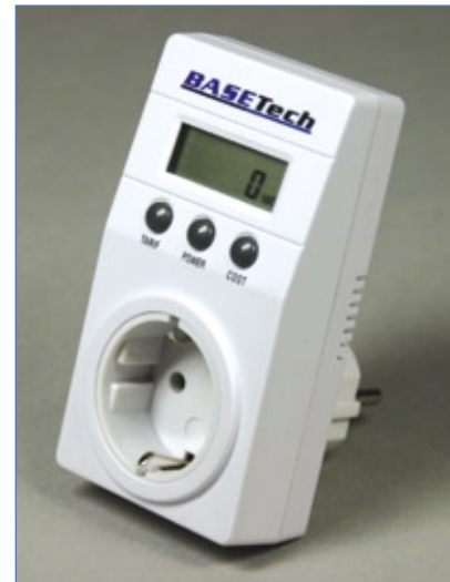
Figura 2 Um simples amperímetro plugável mede o consumo de energia.
