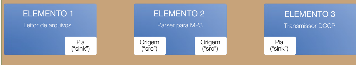
Figura 1 Exemplo de pipeline GStreamer com três elementos: um leitor de arquivo, um codificador MP3 e um transmissor DCCP.
