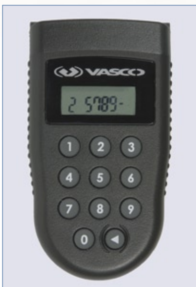
Figura 1 Exemplo de token que utiliza a técnica desafio-resposta. O usuário digita o desafio pelo teclado do token e lê a resposta na tela.
