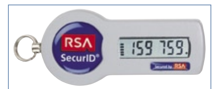
Figura 2 Exemplo de token que codifica a hora atual e a chave interna. A tela exibe um número (PIN) diferente a cada minuto.
