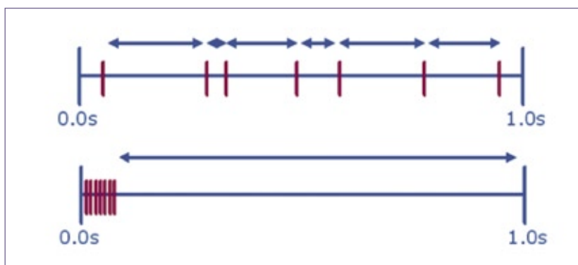
Figura 1 Ao agruparmos timers, conseguimos fazer com que o processador seja acionado durante um tempo menor e permaneça por mais tempo no estado ocioso.
