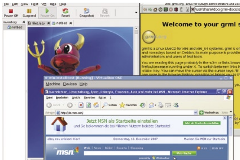
Figura 2 Três sistemas operacionais em três soluções de virtualização: o VMware Server abriga o NetBSD, o KVM oferece um lar ao Linux e o Windows roda no Virtualbox.
