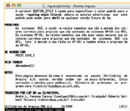
Figura 6: No item VEJA TAMBÉM de uma página de manual você encontrará referências a documentações complementares.
