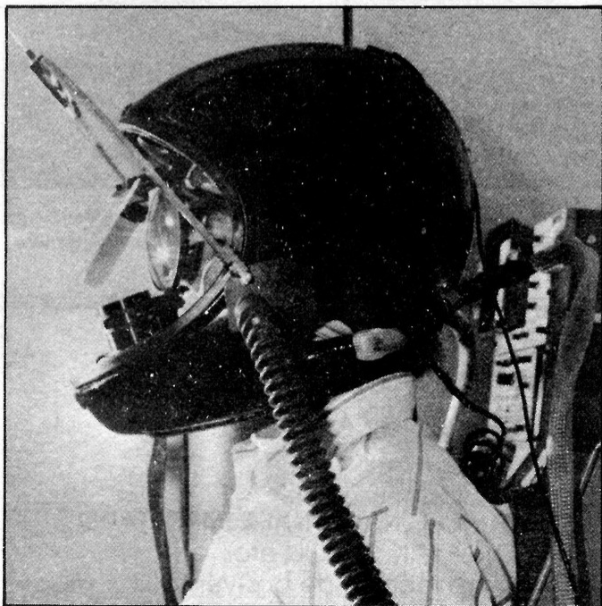
Foto 2: Usado como una herramienta de investigación en la unidad Langley de la NASA, este casco es un simulador de vuelo que permite a los pilotos probar algunas tecnologías como, por ejemplo, seguimiento ocular, reconocimiento de voz y síntesis, y pantallas gráficas tridimensionales.
