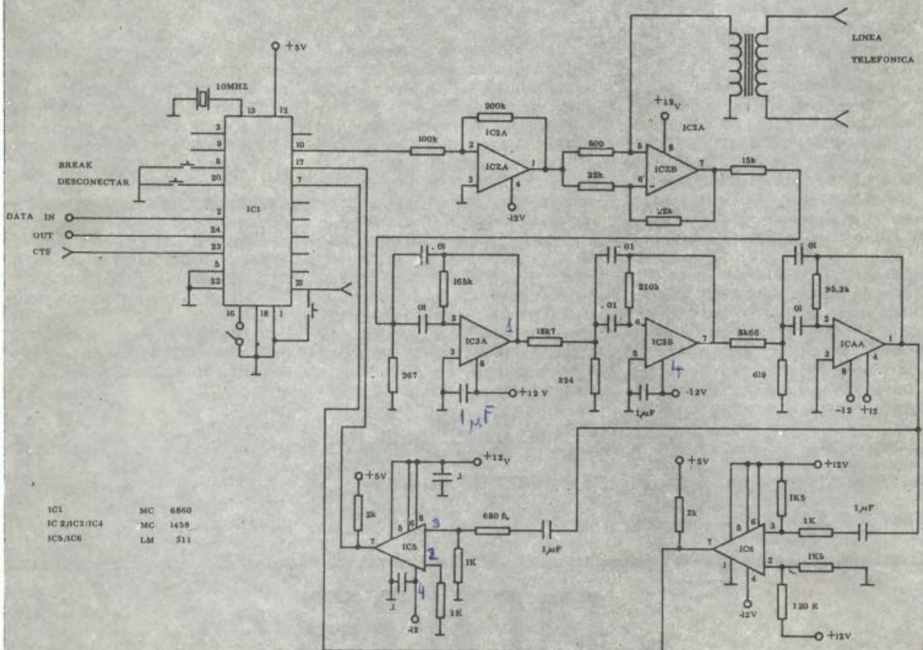
aparecerán convertidos en niveles TTL en la línea DATA OUT (pin 24). Los circuitos integrados IC2, IC3, IC4 e IC5 tienen por fundamento separar los tonos correspondientes a ambos sentidos y asegurar que a los terminales de IC1 lleguen los correctos.
