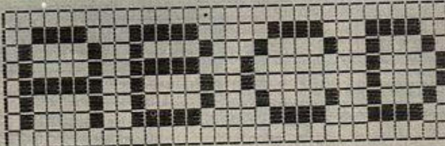
**La sentencia Plot permite realizar gráficos con una resolución de 64 x 44 puntos, cada una con grosor igual a cuatro líneas de barrido. Este programa permite incrementar la resolución a 192 x 178 puntos.**
