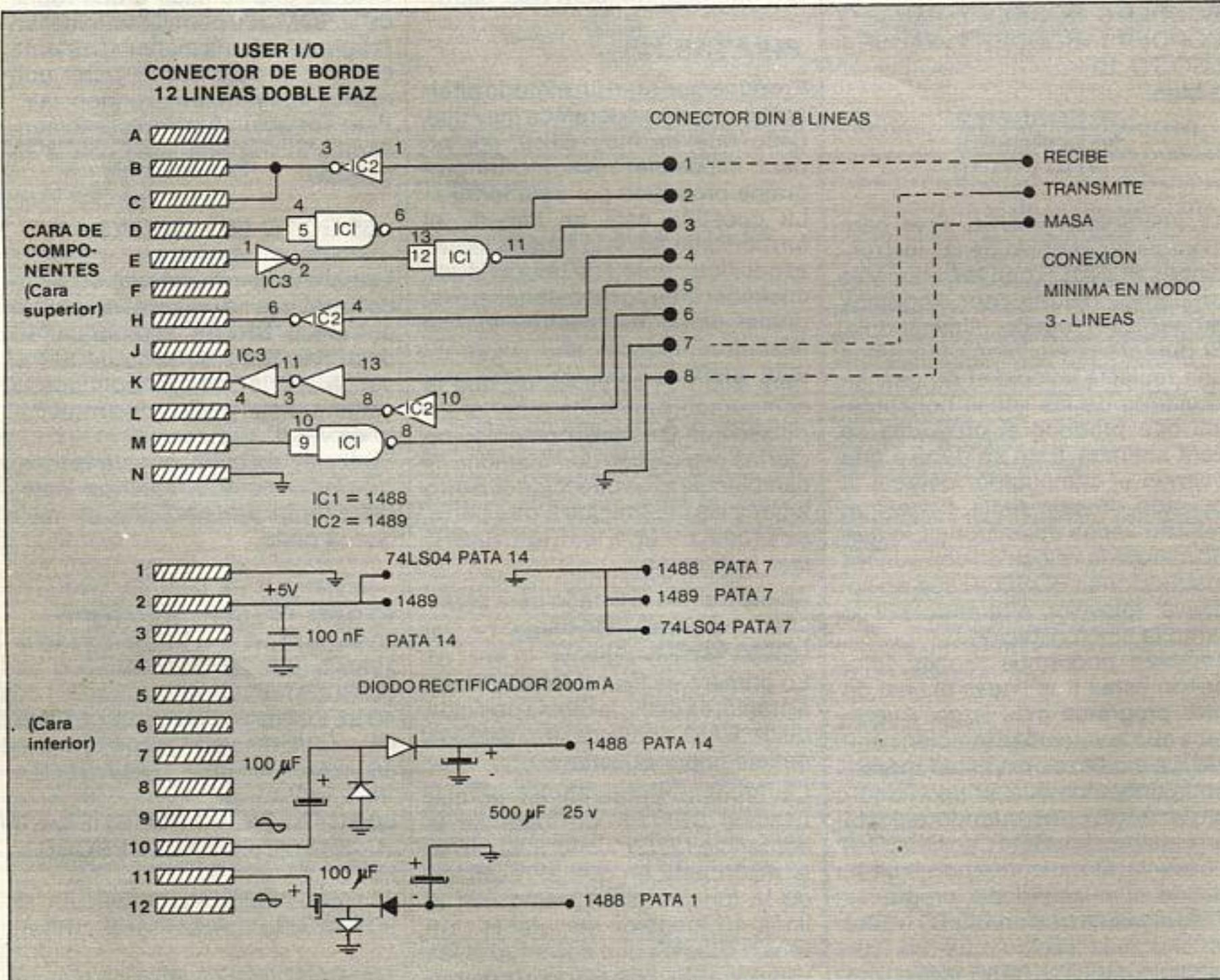
**La microcomputadora Commodore 64 tiene incorporada una interfase serie que se puede usar fácilmente desde el Basic, para enviar y recibir datos desde otra máquina o transmitir a una impresora serie**
