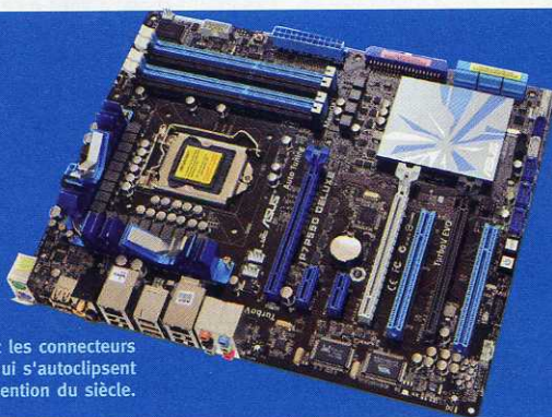
Les 24 phases d'alimentation sont toutes là. Dans la théorie, c'est censé améliorer la stabilité du courant. Dans la pratique...
