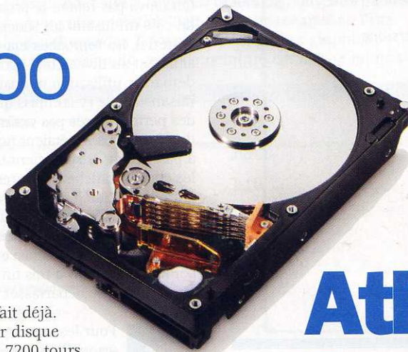
En regardant bien, vous pourrez compter les plateaux du disque.
