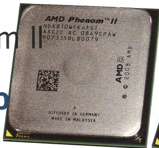
Nos estropiés: à gauche, le Phenom II X4 810, amputé de 2 Mo de cache, à droite le Phenom II X3 720 amputé d'un core.
