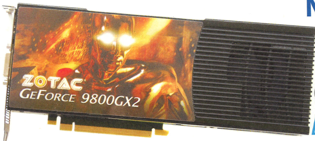
La GX2 se présente sous la forme d'un bloc avec de légères ouvertures pour la ventilation. À l'usage, la carte devient rapidement très chaude.
