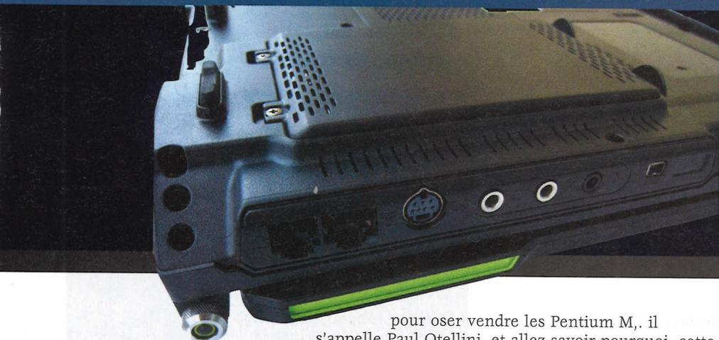
Sur le côté droit de la machine, port modem, réseau gigabit, sortie s-vidéo, divers ports son et une prise mini-USB.
