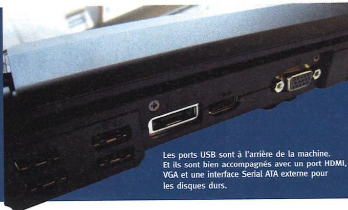
Les ports USB sont à l'arrière de la machine. Et ils sont bien accompagnés avec un port HDMI, VGA et une interface Serial ATA externe pour les disques durs.
