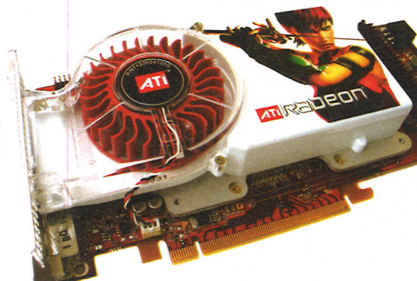
Le système de refroidissement blanc iPod du X1800 XT fait beaucoup moins de bruit que celui des X850 XT.
