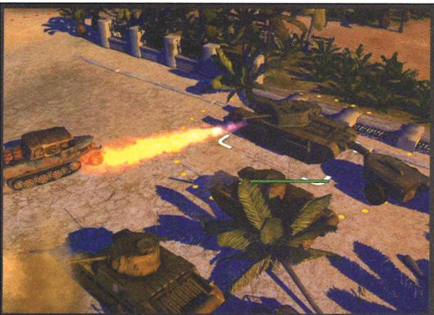
La caravane que tire ce char Crocodile ne contient pas du matériel de camping : c'est un réservoir de carburant pour son lance-flammes.
