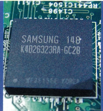
La RAM utilisée sur la GF4 Ti4200 64 Mo (ici le modèle de référence de Nvidia) n'est pas de dernière génération, comme sur les Ti4600 (à droite).
