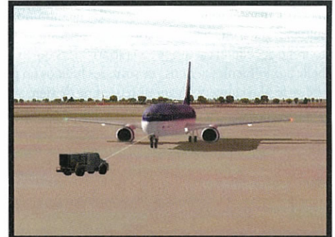
La ligne blanche partant de l'appareil est un guide dont on s'aidera pour positionner les objets avec précision.
