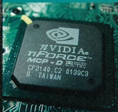
Le South bridge MCP-D est responsable entre autres de toute la partie audio et réseau.
