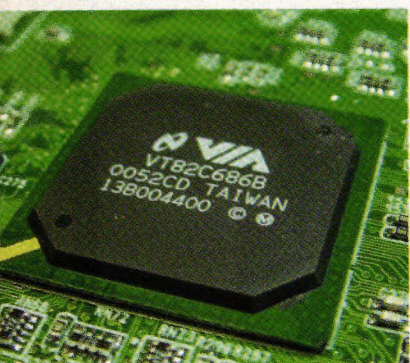
Le Southbridge 686B supporte l'UDMA100, mais n'oubliez pas les patches et drivers...
