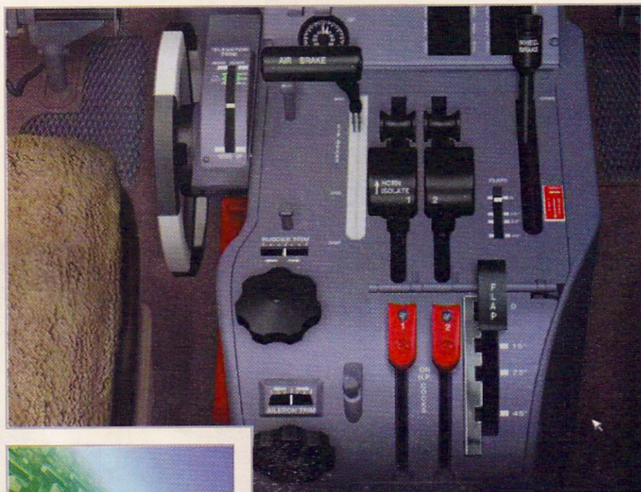
▲ Un panneau central avec les commandes des throttles, des aérofreins et des volets. Les roulettes sont le réglage des trims.
