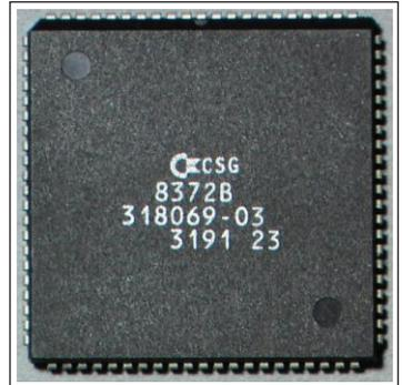
Fig.4: Para que se tenha uma idéia, esse é o “Agnus”, e a foto retrata o produto final daquele monstro de 7 placas que era na fase de protótipo! Foi desenvolvido inteiramente por Jay Miner.
