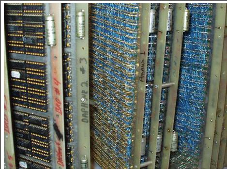
Fig.2: Assim eram os chips Agnus e Daphne (que se tornou Denise), em fase de protótipo. Note que foi usada a técnica de "wire-wrap" para confecção dos circuitos!
