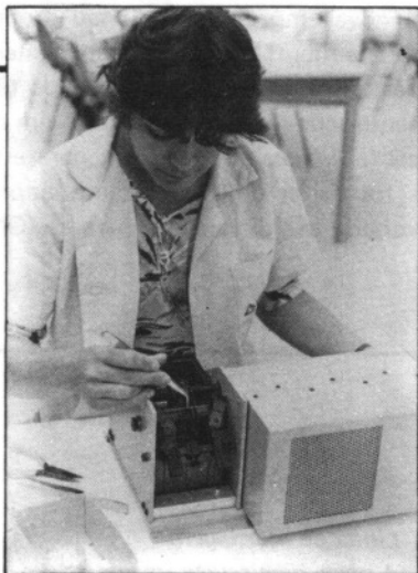
Com o auxílio de uma pinça a operadora posiciona o componente na pré-formadora.
