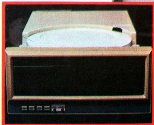
Discos magnéticos Winchester de grandes capacidades estão sendo desenvolvidos em convênio com a PUC
