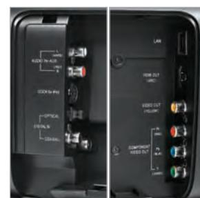
**Conexões** Quase todas as entradas ficam na traseira. Só a USB e a tomada para MP3 player ficam na lateral
