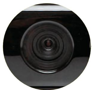
**Sensor infravermelho:** um dos componentes usados para determinar a posição do jogador
