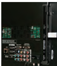
Conexões: opções incluem 4 HDMI e portas USB para pen drive e adaptador Wi-Fi
