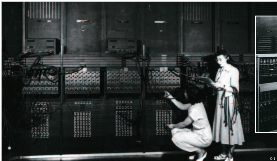
COMPUTADOR EM USO: a programação era feita conectando cabos (à esquerda). A troca de válvulas queimadas era um trabalho diário (acima)
