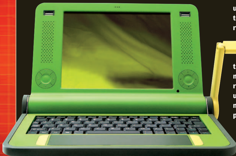
LAPTOP DE 100 DÓLARES: rede mesh e manivela para uso remoto
