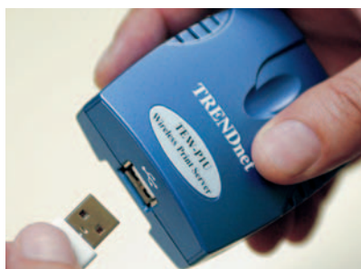
CONEXÃO: o cabo USB é usado para ligar a impressora ao servidor
