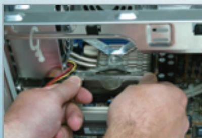
**6** Para encaixar o processador, levante a alavanca que se encontra ao lado do soquete. Alinhe o processador seguindo a marcação de um triângulo existente no chip e no soquete. Baixe a alavanca.
