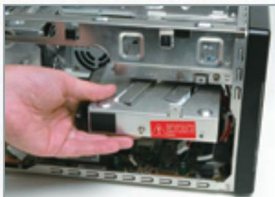
**3** Desparafuse os pontos que seguram a tampa onde será encaixado o DVD e tire-a.
