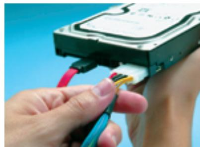
**CONEXÕES NO HD:** cabo Sata e cabo de alimentação de energia
