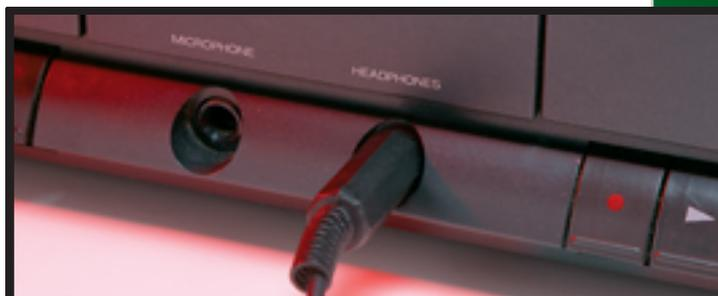
**1** No aparelho de som com o toca-discos ligado, encaixe o cabo na saída de fone de ouvido para plugues P10 estéreo
