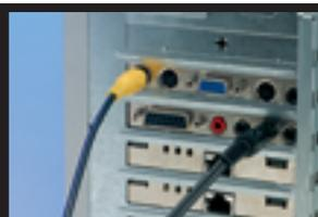
**1** Um cabo RCA faz a conexão de vídeo. Conecte a ponta P2 do cabo de áudio no PC
