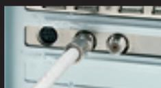
**2** Encaixe o cabo coaxial da TV a cabo na entrada de antena da placa de captura
