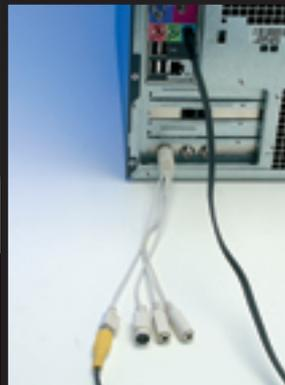
**1** Ligue o conector P2 à placa de som no PC, e, usando o cabinho adaptador, o RCA à placa de captura
