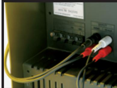
**2** Na entrada auxiliar do mini-system, ligue os plugues RCA vermelho (canal direito) e branco (canal esquerdo) aos conectores correspondentes
