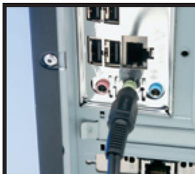
**1** No PC, encaixe o plugue P2 na saída de áudio da placa de som usada pelos alto-falantes, identificada pela cor verde
