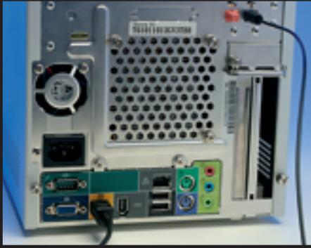
**1** Encaixe o plugue S-Video na placa de vídeo e o Toslink na saída óptica da placa de som
