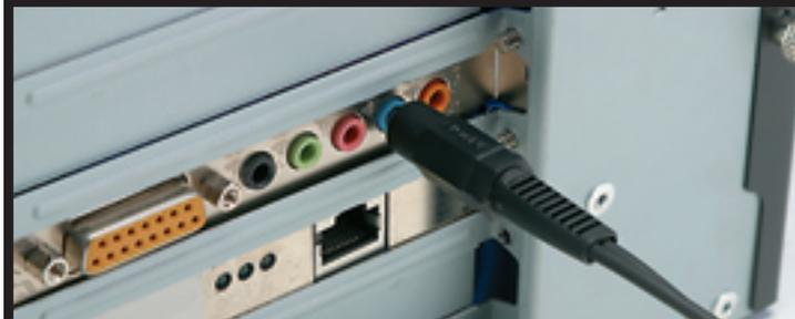
**2** A outra ponta do cabo, com um plugue P2 estéreo, é ligada à entrada Line In, identificada pela cor azul, da placa de som do micro
