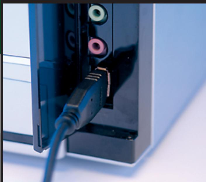
**1** Na porta USB do computador, coloque a ponta do cabo com o conector USB tipo A
