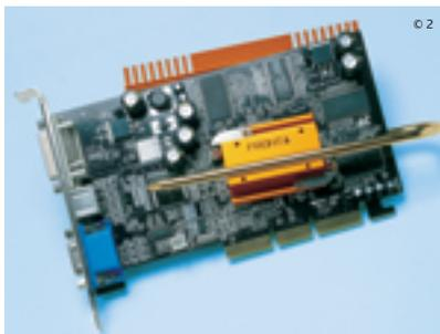
**MONTAGEM:** o termoduto (tubo em forma de U) se encaixa no captador de calor
