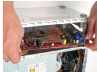
**6 COLOCANDO A PLACA DE VÍDEO** Agora o barebone já tem tudo para funcionar normalmente. Mas queremos uma máquina capaz de encarar games. Para isso, escolhemos uma placa de vídeo GeForce4 Ti4200, da MSI. Devemos encaixá-la com cuidado no slot AGP do barebone, evitando que os cabos do micrinho fiquem presos pela placa. Depois, só é preciso instalar os drivers da placa de vídeo para ela funcionar. 🎮
