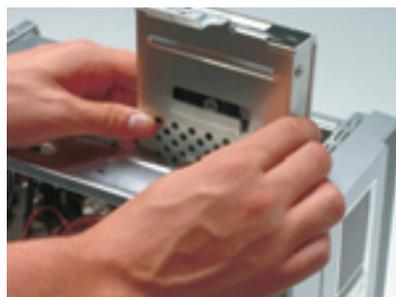
**4 INSTALANDO O HD** No barebone, o HD fica numa bandeja, que se move por uma trilha dentro do gabinete. A fim de instalar o HD, precisamos tirar a bandeja feita para ele. Para isso, remova o parafuso que a fixa ao gabinete. Com a bandeja solta, basta colocar e parafusar o HD. Aproveite para encaixar também o cabo de dados e o de energia. Finalmente, ponha a bandeja e seu parafuso de volta.
